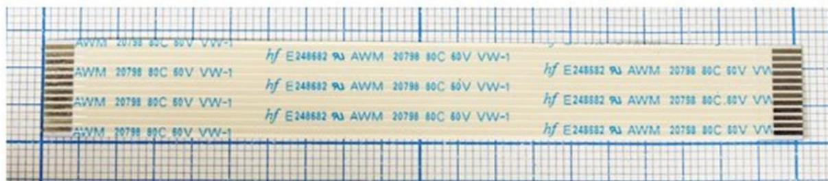
**Шлейф представляет из себя гибкий соединитель длиной 100 мм и шириной 13 мм. Количество контактов 12, шаг 1 мм.**
