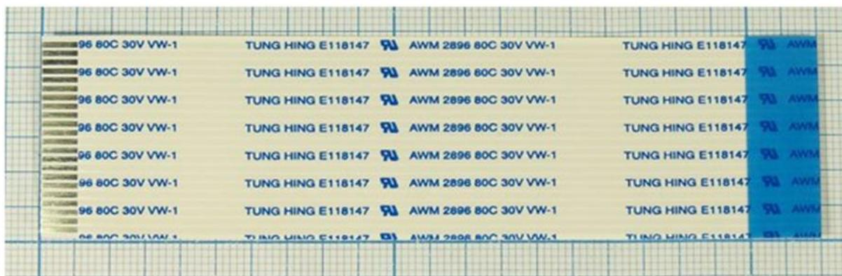
Шлейф представляет из себя гибкий соединитель длиной 110 мм и шириной 29 мм. Количество контактов 22, шаг 1,25 мм.
