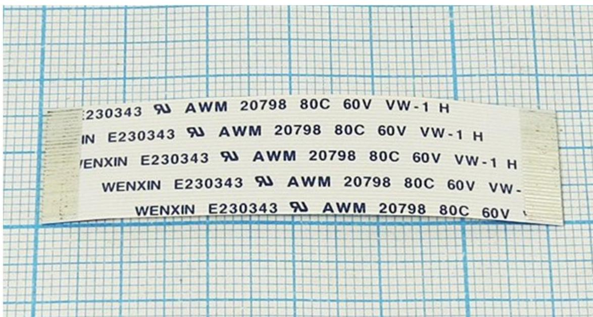
Шлейф представляет из себя гибкий соединитель длиной 58 мм и шириной 15,5 мм. Количество контактов 30, шаг 0,5 мм.
