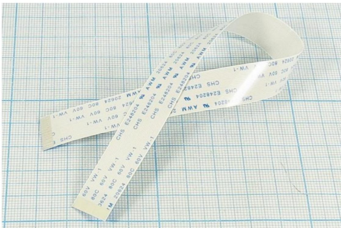
Шлейф представляет из себя гибкий соединитель длиной 220 мм и шириной 13,5 мм. Количество контактов 26, шаг 0,5 мм.
