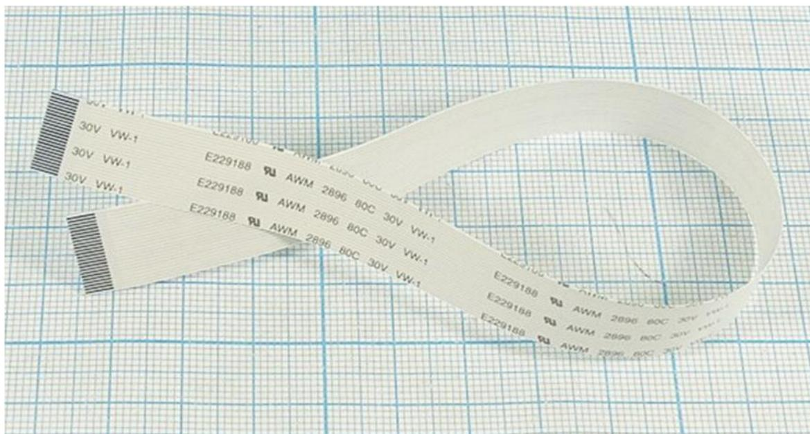
Шлейф представляет из себя гибкий соединитель длиной 240 мм и шириной 12,5 мм. Количество контактов 24, шаг 0,5 мм.
