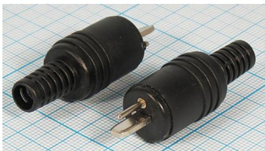
DIN-разъём для акустических систем, называемый также «точка-тире». Поляризованный двухконтактный неэкранированный разъём, разработанный для подключения громкоговорителя к усилителю мощности звуковой частоты или другому устройству. Он существует в виде гнезда для монтажа на панель. Гнезда или штекера на кабель. Круглый контакт подключается к положительному полюсу (красный), а плоский — к отрицательному (чёрный).
