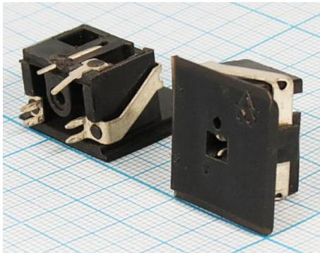
DIN-разъём для акустических систем, называемый также «точка-тире». Поляризованный двухконтактный неэкранированный разъём, разработанный для подключения громкоговорителя к усилителю мощности звуковой частоты или другому устройству. Он существует в виде гнезда для монтажа на панель. Гнезда или штекера на кабель. Круглый контакт подключается к положительному полюсу (красный), а плоский — к отрицательному (чёрный).
