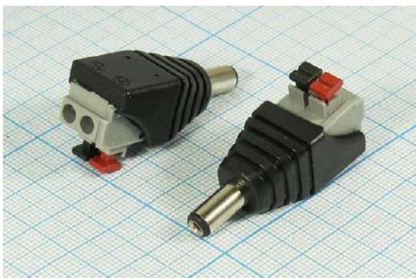
Разъем питания штекер 2.1x5.5 с быстрозажимной колодкой предназначен для оперативного подключения питания различного оборудования (систем видеонаблюдения, питания зарядных или других бытовых устройств) к источнику питания постоянного тока 12/24В (DC). Такой двухконтактный штекер монтируется на кабель без использования какого-либо
