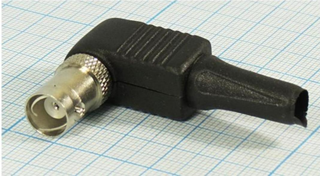
**Разъемы предназначены для быстрого монтажа без применения пайки. Крепление центрального проводника производится винтом, оплетка кабеля обжимается. Возможно применение различных коаксиальных кабелей. Пятидесятиомные версии разъемов этой серии работают до 11 ГГц.**
