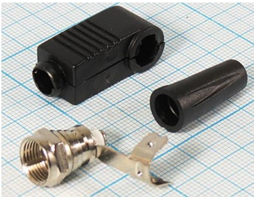
**Разъемы предназначены для быстрого монтажа без применения пайки. Крепление центрального проводника производится винтом, оплетка кабеля обжимается. Возможно применение различных коаксиальных кабелей с внешним диаметром оболочки до 6 мм. Центральный контакт и корпус разъема никелированы. Изолятор изготовлен из фторопласта.**
