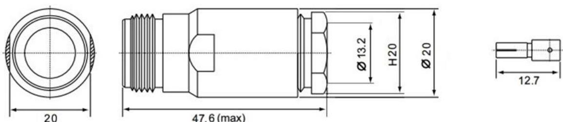
Разъем имеет позолоченный центральный проводник и хромированный корпус. Изолятор, как правило, изготовлен из фторопласта или из бакелита.
