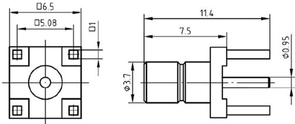
Гнездо имеет позолоченный центральный проводник и позолоченный корпус. Изолятор, как правило, изготовлен из фторопласта.
