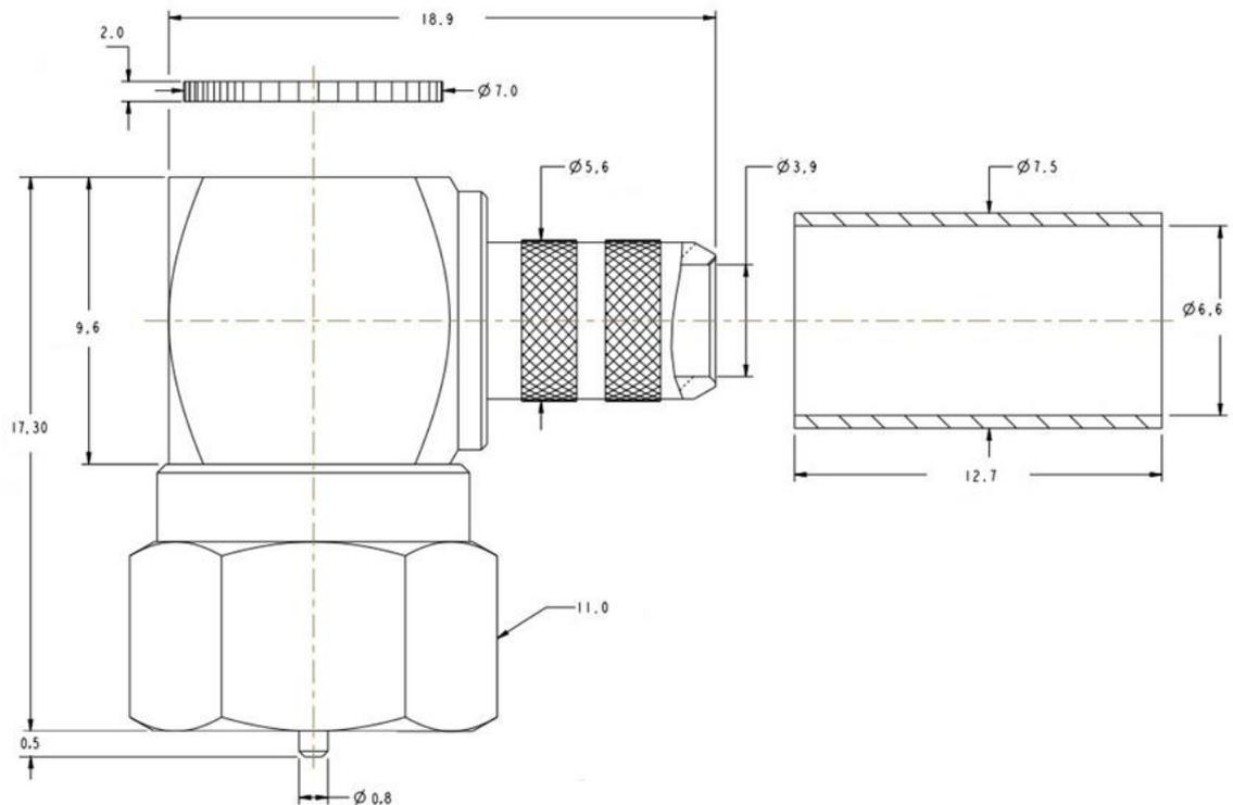
**Разъем имеет центральный позолоченный контакт и никелированный (хромированный) корпус. Изолятор изготовлен из фторопласта. Для монтажа применяется специальный обжимной инструмент.**
