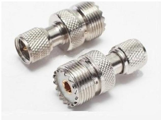
**Переходник предназначен длястыковки кабелей и приборов, имеющих соответствующие ответные части ВЧ разъемов стандарта mini-UHF и UHF. Переходник имеет позолоченный центральный проводник и хромированный корпус. Изолятор, как правило, изготовлен из фторопластика.**
