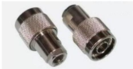
**Переходник предназначен длястыковки кабелей и приборов, имеющих соответствующие ответные части ВЧ разъемов стандарта N и FME. Переходник имеет позолоченный центральный проводник и хромированный корпус. Изолятор изготовлен из фторопласта или из бакелита.**
