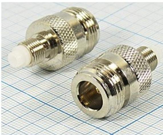
Переходник предназначен для стыковки кабелей и приборов, имеющих соответствующие ответные части разъемов FME и N-типа. Переходник имеет позолоченный центральный проводник и хромированный корпус. Изолятор, как правило, изготовлен из фторопласта.
