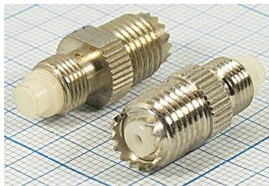
**Переходник предназначен длястыковки кабелей и приборов, имеющих соответствующие ответные части разъемов FME и mini-UHF. Переходник имеет позолоченный центральный проводник и хромированный корпус. Изолятор, как правило, изготовлен из фторопластика.**
