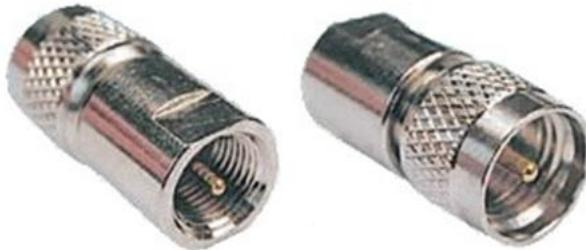
**Переходник предназначен длястыковки кабелей и приборов, имеющих соответствующие ответные части разъемов FME и mini-UHF. Переходник имеет позолоченный центральный проводник и хромированный корпус. Изолятор, как правило, изготовлен из фторопласта.**
