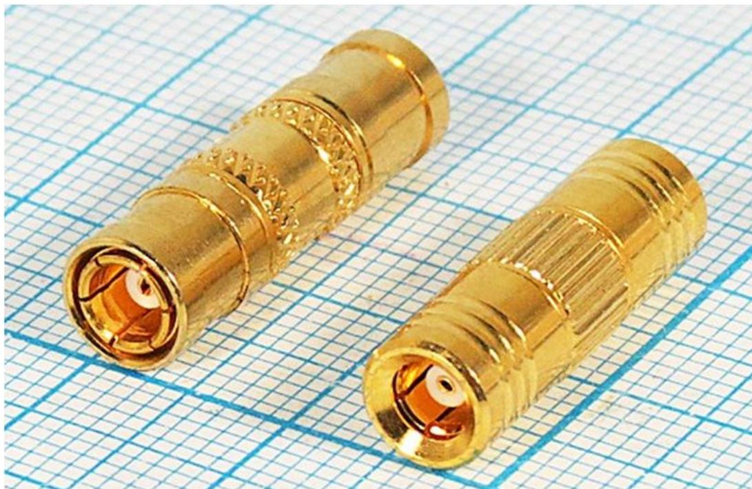
**Переходник предназначен длястыковки кабелей и приборов, имеющих соответствующие ответные части разъемов стандарта SMB. Переходник имеет позолоченный центральный проводник и позолоченный корпус. Изолятор, как правило, изготовлен из фторопластика.**
