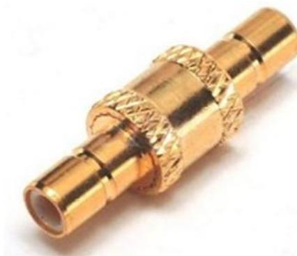
Переходник предназначен для стыковки кабелей и приборов, имеющих соответствующие ответные части разъемов стандарта SMB. Переходник имеет позолоченный центральный проводник и позолоченный корпус. Изолятор, как правило, изготовлен из фторопластика.
