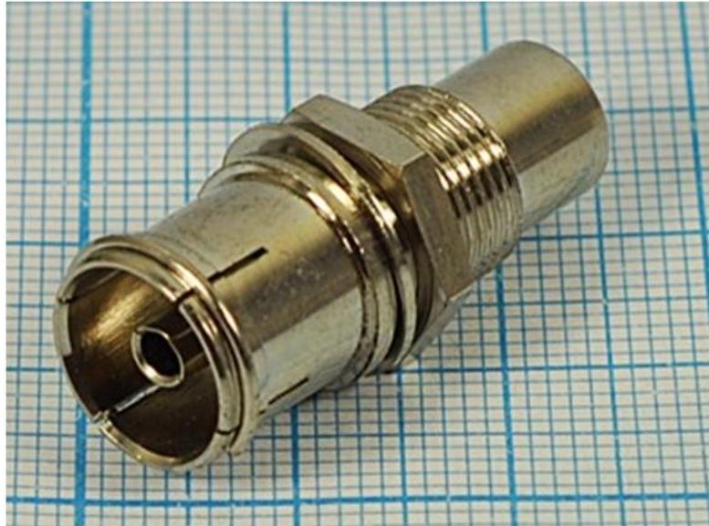
**Переходник имеет никелированный центральный контакт и никелированный корпус. Материал изолятора допускает применение фторопласта, полиэтилена, полистирола и др. Всё зависит от производителя, от его генеральной линии: произвести продукт с высокими техническими параметрами, либо завалить рынок недорогими изделиями, сведя затраты на материалы, их обработку и производство до минимума.**
