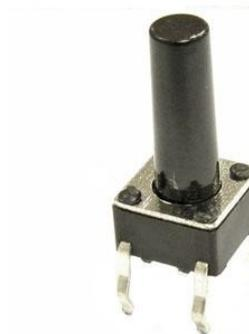
Тактовая кнопка KAN0611 - 1301B, 6x6x13 мм, OFF-(ON), 50 мА, 12 В, 100 мОм – это разновидность простейших механических выключателей, обеспечивающая замыкание контактов (без фиксации) только при наличии давления на поверхность штока (толкателя).
