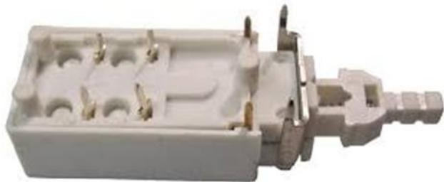
Сетевой выключатель имеет три группы контактов: две силовые группы, с максимальным током нагрузки 4 ампера и рабочим напряжением до 250 вольт, и одной слаботочной группой, с рабочим напряжением 24 вольта и током нагрузки до 100 мА.
