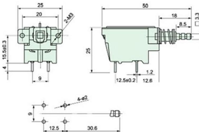
Сетевой выключатель имеет две группы контактов с максимальным током нагрузки 8 ампер для каждой группы.
