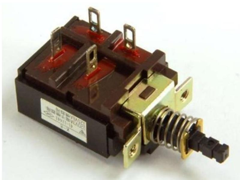
Сетевой выключатель имеет две группы контактов с максимальным током нагрузки 5 ампер для каждой группы.
