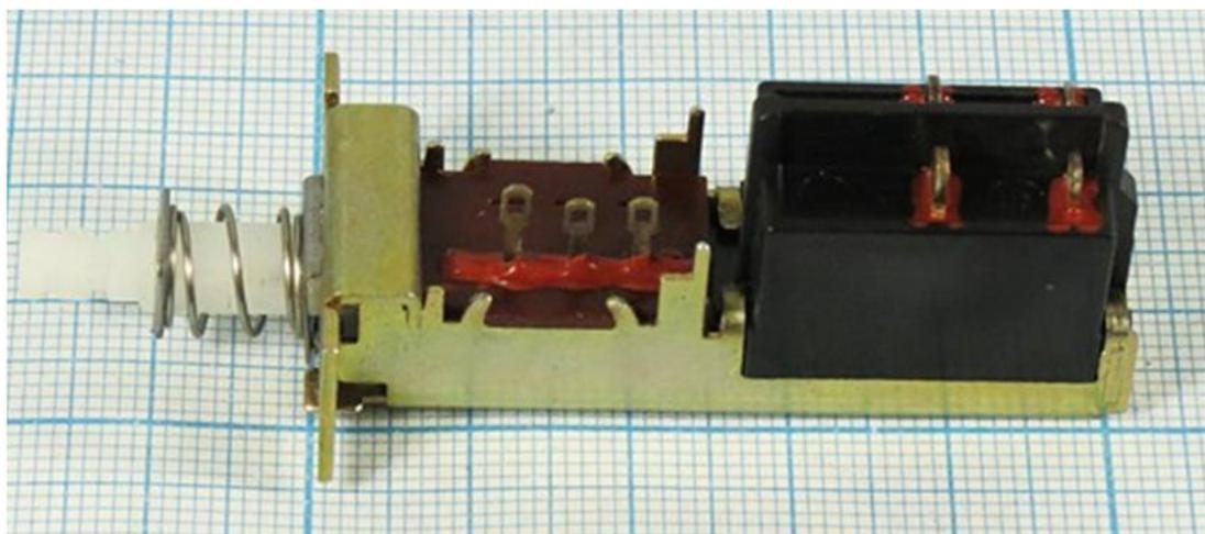
Сетевой выключатель имеет три группы контактов: две силовые группы, с максимальным током нагрузки 5 ампер и рабочим напряжением до 250 вольт, и одной слаботочной группой, с рабочим напряжением 24 вольта и током нагрузки до 100 мА.
