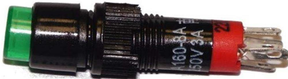
Переключатель предназначен для коммутации электрических цепей с рабочим напряжением 250 вольт и током нагрузки 3 ампера. Посадочный диаметр на приборную панель 8 мм.
