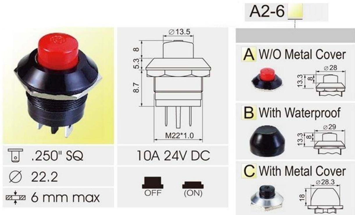
Переключатель предназначен для коммутации электрических цепей с рабочим напряжением 24 вольта и максимальным током нагрузки 10 ампер. Посадочный диаметр крепления на приборную панель 22,2 мм.
