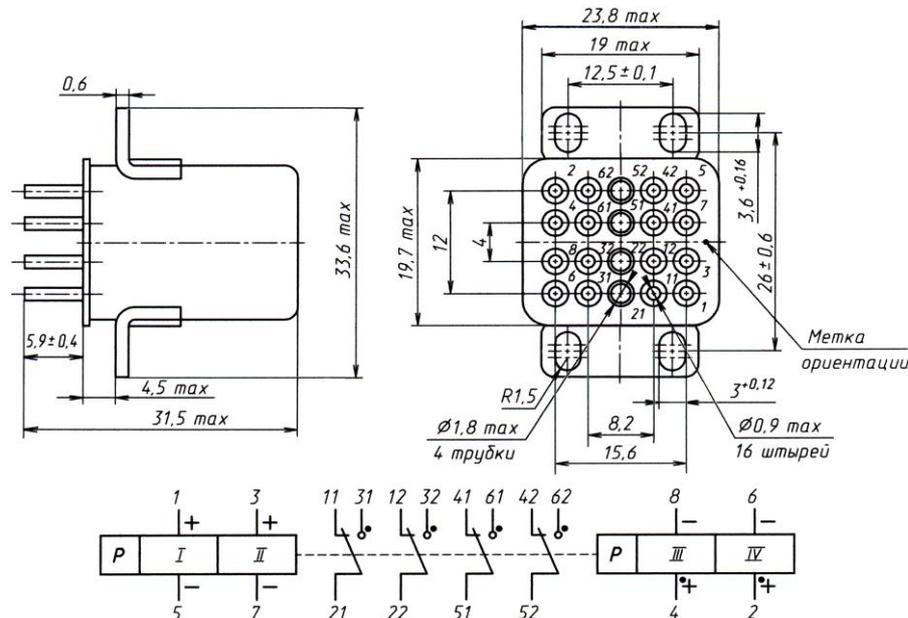
**Масса реле**, не более: 43 г – РПС34А исполнения без угольников (PC4.520.231...PC4.520.248, PC4.520.281...PC4.520.285); 45 г – РПС34Б исполнения с угольниками (PC4.520.231-01...PC4.520.248-01, PC4.520.281-01... PC4.520.285-01).
