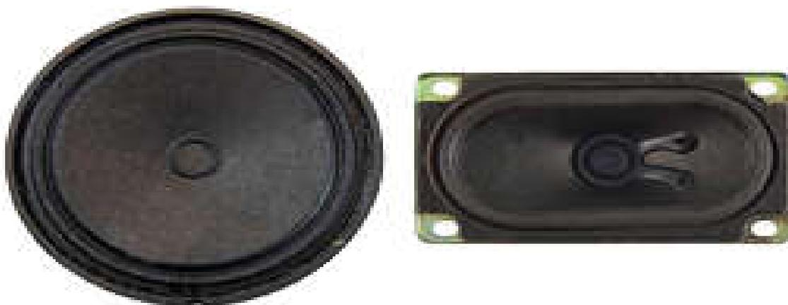
Электродинамические головки (динамики) серий DXI, DXP, DXY – преобразователи электрических сигналов в акустические звуковые волны – звук. Динамические головки DXI, DXP, DXY прямого типа излучения: электрический ток звуковой частоты подается на катушку в постоянном магнитном поле, приводя её в колебания с частотой звука. Катушка жестко зафиксирована с диффузором, который и преобразовывает механические колебания катушки в колебания звуковых волн.
