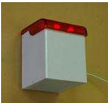
Предназначен для светового и звукового оповещения о состоянии объекта, охраняемого при помощи приборов приёмно-контрольных охранно-пожарных или систем охранно-пожарной и тревожной сигнализации. Электропитание оповещателя осуществляется от источника 12 или 24В постоянного тока. Прибор развивает звуковое давление не менее 100дБ на 1м.
