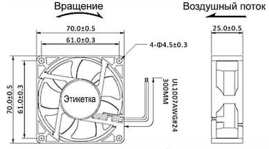
Монтажные размеры (ед. измерения: мм)
