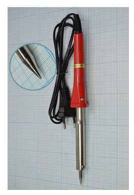
Паяльник серия Classic мощностью 80Вт PROconnect предназначен для ручного монтажа/демонтажа деталей среднего размера и лужения. Подходит как для любительского, так и для профессионального использования. Долговечное жало паяльника состоит из медьсодержащего сердечника, покрытого слоем хрома. В случае необходимости его можно легко и быстро заменить (сменное жало в комплект не входит).
