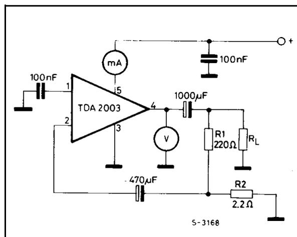
**AC TEST CIRCUIT**
