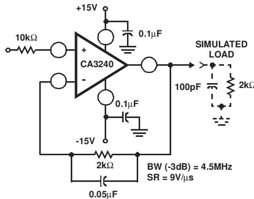
**FIGURE 1C. TEST CIRCUIT**
