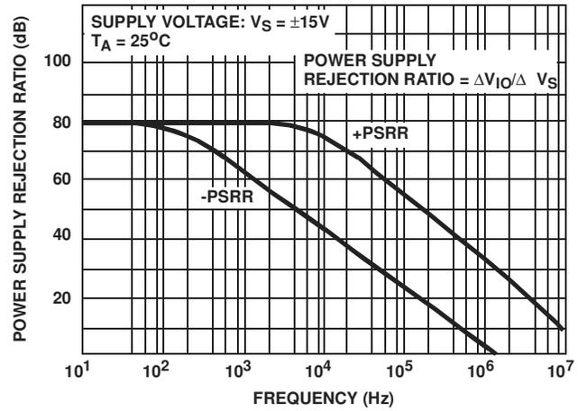
FIGURE 20. POWER SUPPLY REJECTION RATIO vs FREQUENCY
