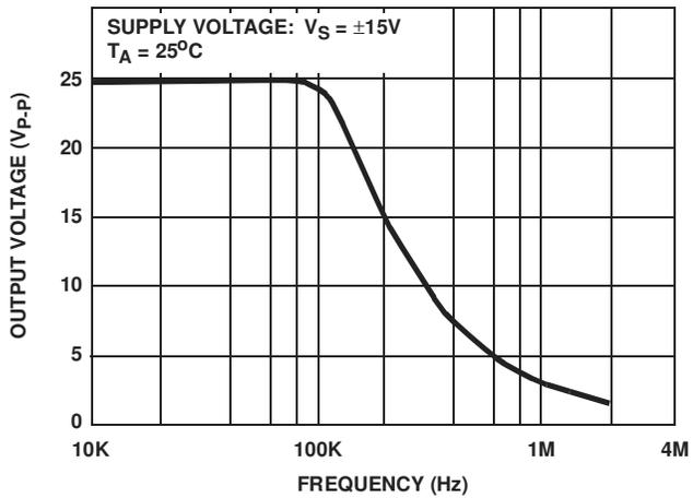
FIGURE 17. MAXIMUM OUTPUT VOLTAGE SWING vs FREQUENCY
