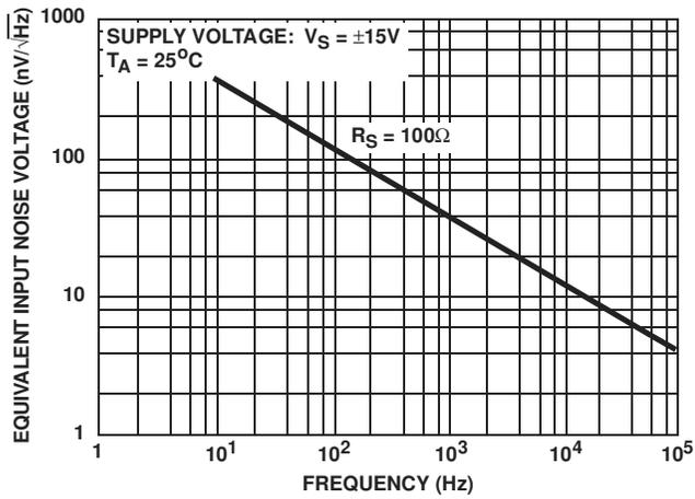
FIGURE 19. EQUIVALENT INPUT NOISE VOLTAGE vs FREQUENCY
