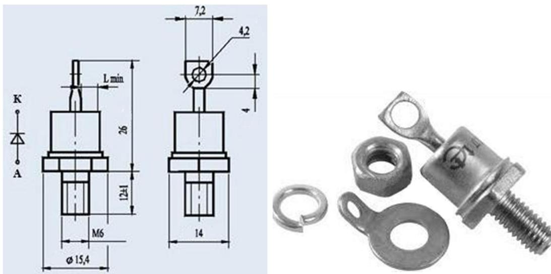
Выпускаются в металлокерамическом корпусе с жестким выводом прямой полярности.
