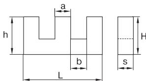
Выпускаются ШП-образные сердечники с зазором для снижения влияния подмагничивающего поля и расширения рабочего диапазона частот, а также низкопрофильные сердечники типа Ш и ШП для изготовления малогабаритных микромодульных источников питания с частотой до 1 МГц.
