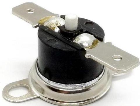
Термостат биметаллический KSD303 с ручным сбросом предназначен для размыкания силовой электрической цепи при достижении температуры в 150°C. Возврат в исходное состояние происходит посредством нажатия на кнопку сброса. Крепление с помощью подвижной скобы.
