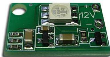
Стробоскоп светодиодный - это модуль состоящий из платы с ярким светодиодом. Стробоскопы применяются в различных областях. Для декорации витрин и привлечения внимания покупателей, в рекламных конструкциях, в клубах, на дискотеках и т.д. и т.д.
