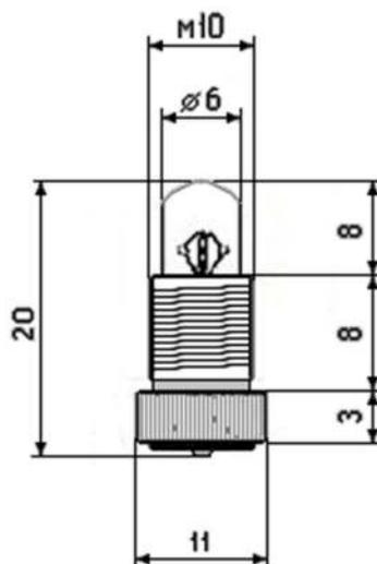
Сигнальная лампа накаливания СГ-28-1,4 предназначена для использования в бортовом аэронавигационном оборудовании,
