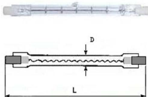
**Лампы предназначены для работы в светильниках наружного и внутреннего освещения в сетях переменного тока частоты 50 Гц. Рабочее напряжение 220 вольт, мощность 500 вт. Длина  $L = 120$ мм, диаметр  $D = 10$ мм. Световой поток 9000 лм. Цоколь R7s.**
