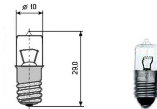
Лампа отличается от обычной лампы повышенной виброустойчивостью и толщиной нити накаливания - её ресурс измеряется количеством "включений / выключений". Колба лампы заполнена инертным газом криптоном, что увеличивает долговечность и к.п.д. В настоящее время этот тип ламп вытесняется светодиодными, которые в силу своей конструкции ещё меньше подвержены фактору разрушения от вибрации и имеют значительно больший ресурс эксплуатации.
