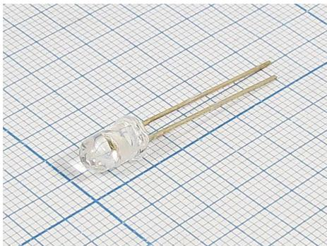
Светодиод со встроенным в корпус резистором
