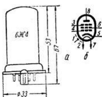
Предназначен для усиления напряжения высокой частоты.
