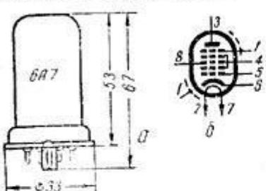
Предназначен для преобразования частоты.
