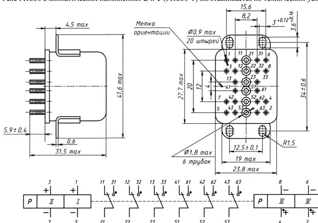
**Масса реле**, не более: 50 г – РПС36А исполнения без угольников (PC4.520.251...PC4.520.268, PC4.520.276...PC4.520.280); 52 г – РПС36Б исполнения с угольниками (PC4.520.251-01...PC4.520.268-01, PC4.520.276-01... PC4.520.280-01).
