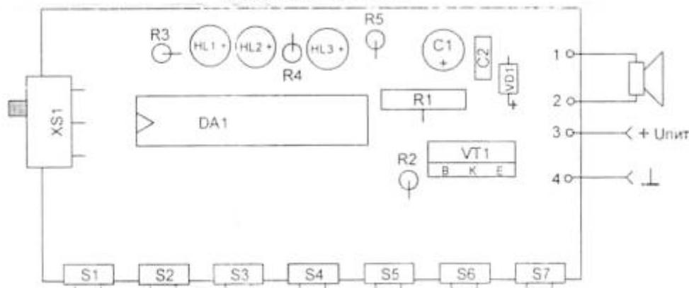
R1 - установка опорной частоты генератора;
