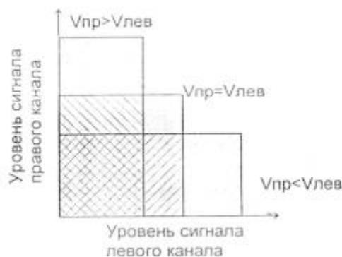
В зависимости от уровня входного сигнала на матричном поле загорается квадрат из светодиодов. В случае разбалансировки каналов или разности уровня в них форма квадрата изменяется (см рис.)
