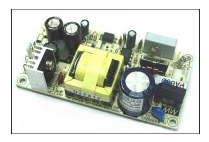
Надежный импульсный источник питания, обладающий малыми габаритами, минимальным числом внешних пассивных элементов обвязки, широким диапазоном питающих напряжений.
