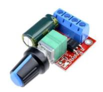
ШИМ регулятор - диммер постоянного напряжения DC до 40 В. Можно использовать для регулировки яркости светодиодных лент и светодиодов, управлять температурой нагрева паяльника, а также он позволяет регулировать обороты электромоторов постоянного тока и управлять другой нагрузкой DC не более 90 Вт. Модуль имеет встроенный светодиодный индикатор сигнализирующий о включении. Потенциометр совмещен с выключателем питания.
